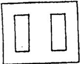
左圖變壓器鐵心是①三相內鐵式②單相外鐵式③單相內鐵式④三相外鐵式。
