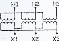
左圖變壓器為①Y-Y②Δ-Δ③Y-Δ④Δ-Y 接線。
