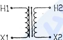
左圖變壓器所標示的極性記號是①正確的②只有高壓側正確③只有低壓側正確④全部不正確。
