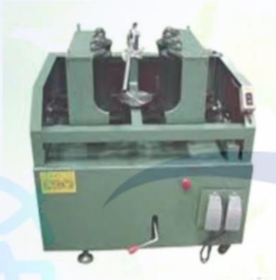
399. (2) 圖示之製茶機具俗稱①解塊機②團揉機③篩分機④束包機。
