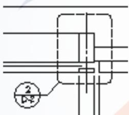
29. (1) 下圖為單元式帷幕牆平面圖，圖中標示表示該索引符號指向 ①圖號 D2 之第 2 個圖 ②圖號 2 之第 D2 個圖 ③圖號 D1 之第 2 個圖 ④圖號 2 之第 D1 個圖 。
