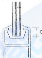
39. (2) 下圖為帷幕牆框架與玻璃安裝之斷面細部詳圖，圖中部位 D 係指 ①面預留縫 ②玻璃 ③膠條 ④框架溝深 。
