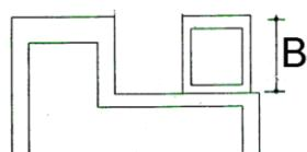
37. (2) 下圖為帷幕牆框架與玻璃安裝之斷面細部詳圖，圖中部位 B 係指 ①面預留縫 ②玻璃墊塊高度 ③崁入深度 ④框架溝深 。
