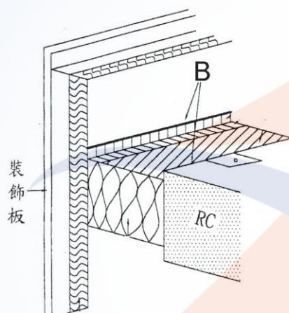
44. (1) 下圖為帷幕牆層間塞處理方式之示意圖，圖中部位 E 級指 ①防火隔熱岩棉
